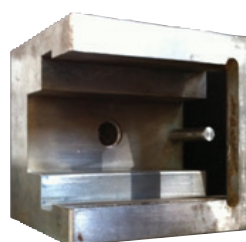
Bloc moule partie mobile
