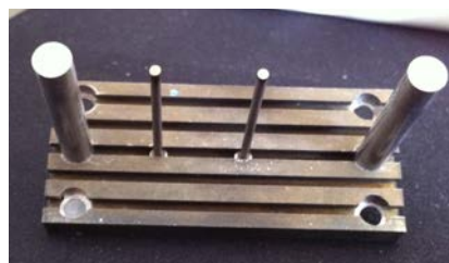
Plaque éjection avec RAZ et éjecteurs
