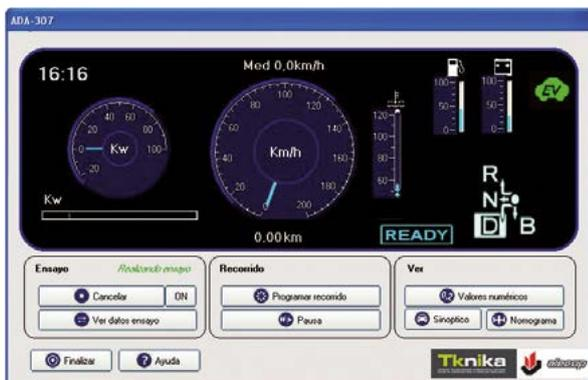
El entrenador hardware, permite simular la conducción (marchas, velocidad, situación de batería, nivel de gasolina, etc.). Todas las acciones que se realizan en el panel tienen su reflejo en el panel de instrumentación software.
