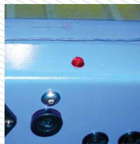
**Pilotos de señalización.** Incorpora piloto rojo de señalización de bancada conectada a red eléctrica, así como piloto verde de señalización de bancada con guarda cerrada y bloqueada.
