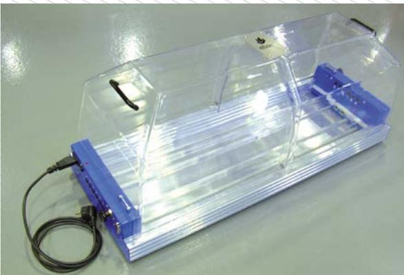
**Paro automático.** Desactivando cualquiera de los dos enclavamientos laterales se interrumpe el suministro de potencia, provocando la parada de las máquinas eléctricas.
