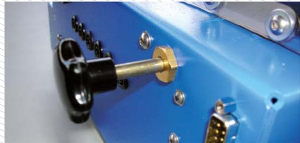
**Bornas de seguridad laterales.** Dispone de dos grupos de doce bornas de seguridad, seis internas y seis externas, uno a cada lado de la bancada. Esto permite la conexión de las máquinas eléctricas a las fuentes de alimentación y/o circuitos de control externos.
